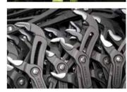
Beim Schmieden wird – genau wie vor 125 Jahren – die Grundlage für die Qualität gelegt. Durch die folgende Wärmebehandlung wird das beste Verhältnis von Härte und Zähigkeit erreicht.
